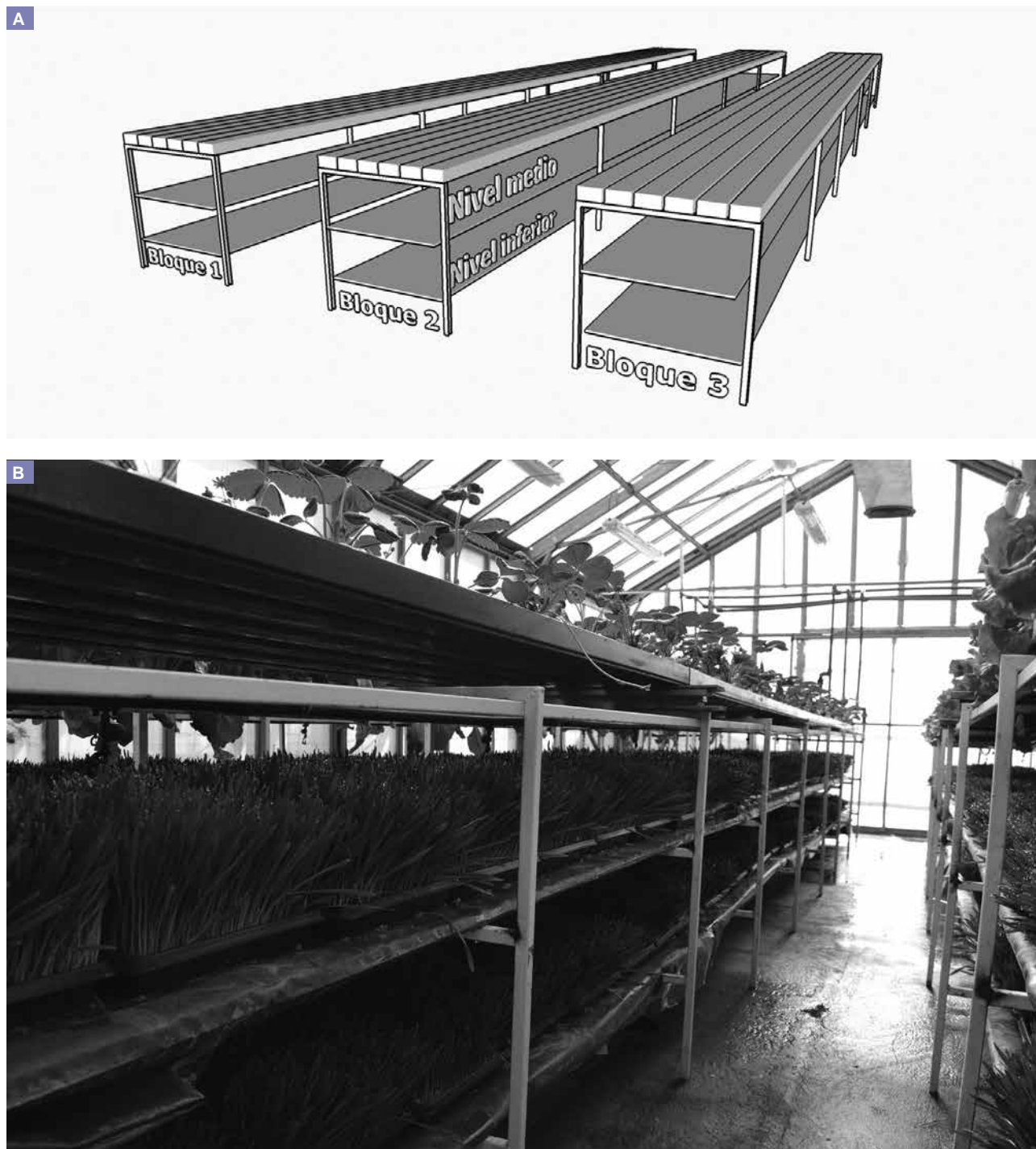
Figura 1. A) Esquema de la disposición de las bandejas para la producción de forraje verde hidropónico (FVH) en un invernadero de Río Gallegos, Santa Cruz. En el nivel superior de la mesada se encuentra emplazado un cultivo de lechuga, como cultivo principal, mientras que el FVH se evaluó en los niveles medio e inferior. B) Foto de una de las mesadas donde se observan las bandejas de forraje en el nivel medio e inferior de esta.
