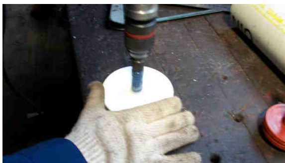
Figura 20 – Perforación de tapa para trampa de sulfhídrico.
