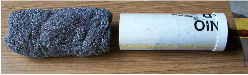
Figura 22 – Relleno del caño con virulana de acero.
