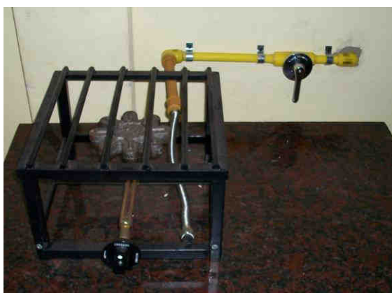
Figura 39 – Quemador de biogás.
