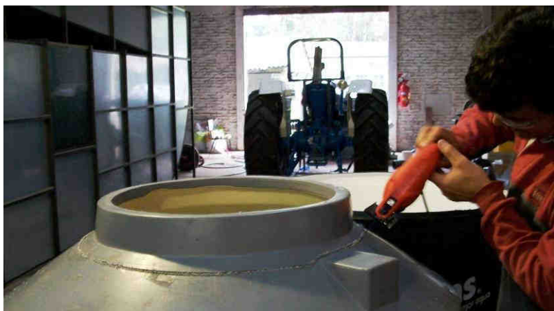
Figura 18 – Corte del tanque de menor diámetro por debajo de la boca del mismo.
