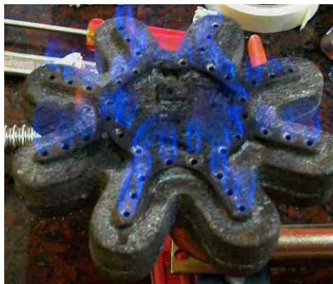
Figura 41 – Llama de biogás azul, estable y sin despegarse de la corona del quemador.
