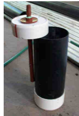
Figura 24 – Vista de caño PVC, salida de tanque y caño de PP de 25 cm.
