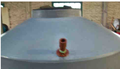
Figura 7 – Vista externa caño camisa
