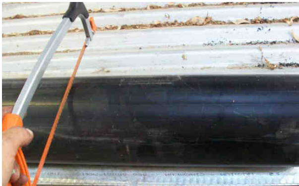
Figura 23 – Corte de sección de caño de PVC.
