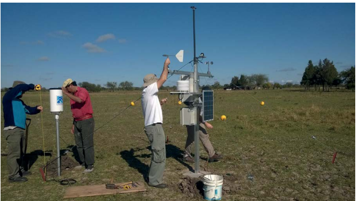
Estación completa donde a simple vista se aprecian sus dos gabinetes (el inferior es el que contiene la batería), el anemómetro, el sensor de radiación solar, la antena, la veleta, el panel solar (por detrás) y el pluviómetro.
