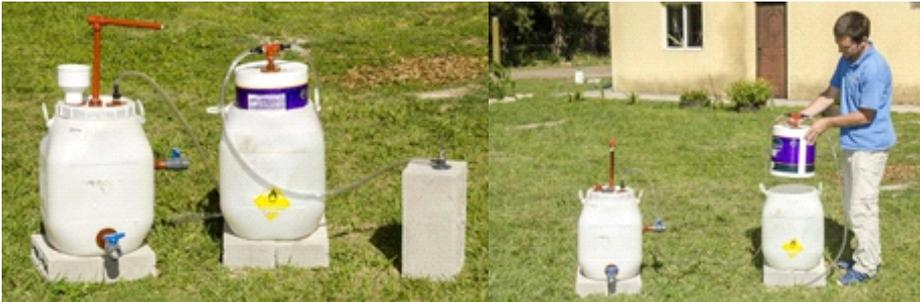
Para finalizar, conectamos el reactor y el gasómetro utilizando 2 m de manguera de polietileno cristal. De igual forma, conectamos otro tramo de manguera del gasómetro al mechero bunsen. La manguera transparente sirve para observar la condensación de agua una vez que el biodigestor entra en funcionamiento.
