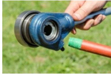
Para el agitador, medimos la altura del recipiente y cortamos un tramo de caño de PP de 1" de 15 cm y otro de aproximadamente 45 cm, de forma tal que alcance a barrer el fondo. Fabricamos roscas con una terraja para conectar los caños y unimos con sella roscas.
