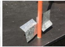
Para la pala de agitación, cortamos un rectángulo de chapa de 15 x 25 cm. Luego generamos 2 cortes enfrentados perpendiculares al lado mayor del rectángulo para poder plegar y dar forma final a la pala. Fijamos con remaches al extremo sin roscar del caño de PP.
