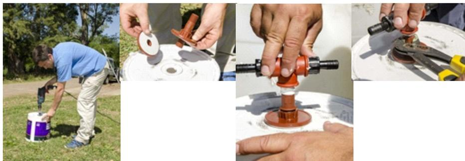
Utilizando una mecha copa de  $\frac{3}{4}$ " , realizamos un agujero en el centro de la base de la campana. Colocamos la salida de tanque de  $\frac{1}{2}$ " con la rosca macho hacia afuera. Con cinta de teflón o sellador, colocamos la TEE y los dos enchufes para manguera. Ajustamos con la ayuda de una llave. Nuevamente, debemos asegurarnos que las conexiones queden bien selladas para evitar fugas de gas.
