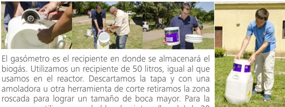
El gasómetro es el recipiente en donde se almacenará el biogás. Utilizamos un recipiente de 50 litros, igual al que usamos en el reactor. Descartamos la tapa y con una amoladora u otra herramienta de corte retiramos la zona roscada para lograr un tamaño de boca mayor. Para la campana, utilizamos un balde de pintura (lavado) de 20 litros. También retiramos la zona roscada, cortando a una altura suficiente para que ingrese sin problemas al contenedor de 50 litros.
