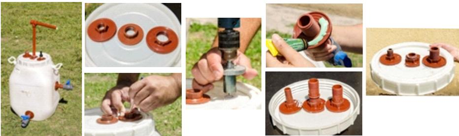
Del lado interno de la tapa, colocamos las salidas de fondo correspondientes a cada uno de los tres orificios, aplicando sella roscas y cinta teflón para sellar bien toda las uniones.
