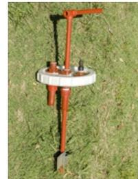
Para integrar el agitador a la tapa, en el orificio central utilizamos una cupla de 1" que conecte la salida de tanque a un tramo de caño de 1" de 20 cm de largo. Por allí pasamos el caño de 45 cm de 1/2" del agitador. Una vez que colocamos el agitador, en el extremo roscado del caño conectamos una TEE de 1/2" junto al caño de 15 cm para formar la manija giratoria.
