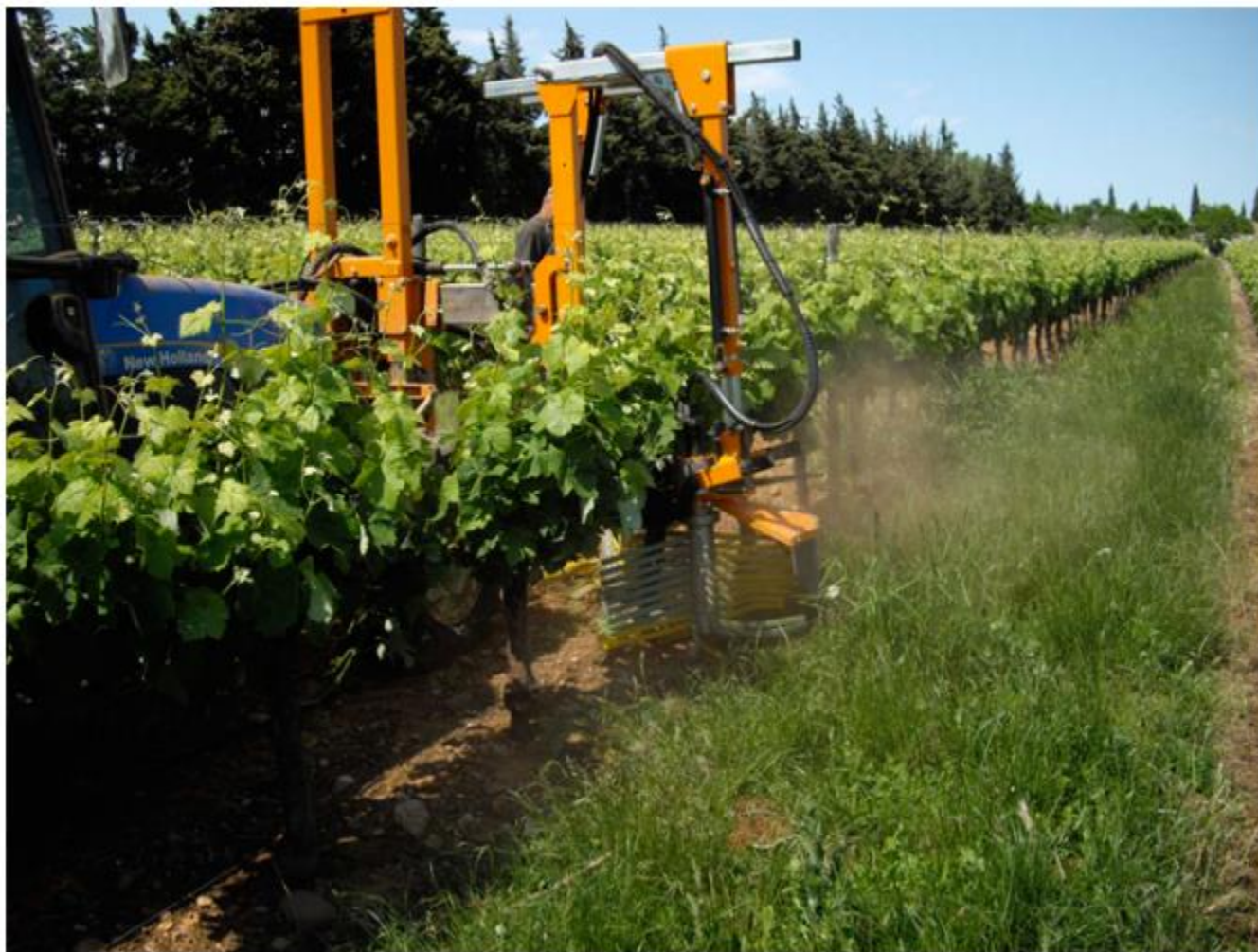
Desbrotadora acoplada a la parte frontal del tractor.
