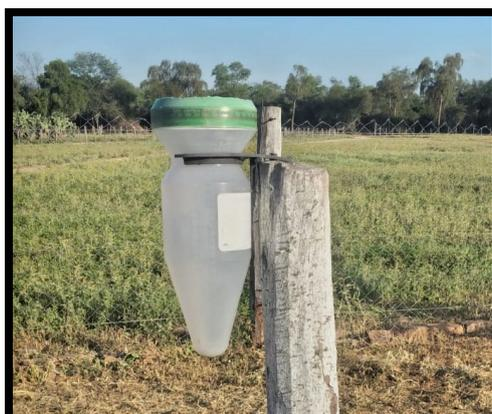
*Imagen 1.- Pluviómetro convencional para la observación y registro de las lluvias caídas*
