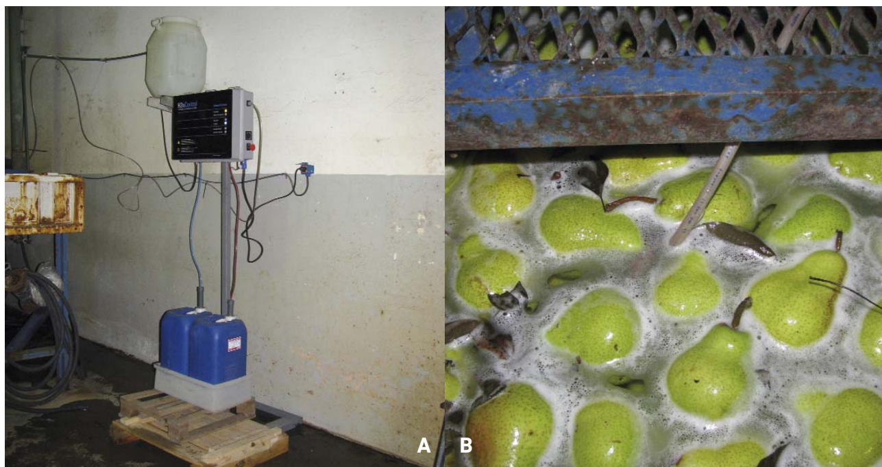
Figura 3. El equipo dosificador (a) realiza la activación del dióxido de cloro estabilizado y lo inyecta directamente en el agua del hidromersor (b) evitando la manipulación directa por un operario (Fuente: INTA EEA Alto Valle, 2012).
