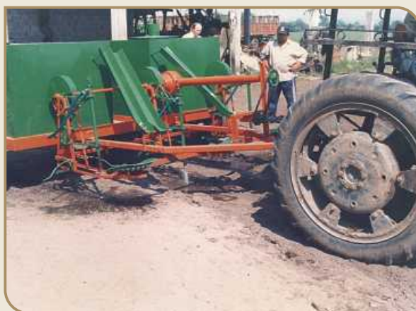
FIGURA 30. Plantadora semimecánica de arrastre.
