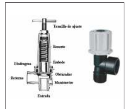
Figura 5: Dos tipos de válvulas manuales aliviadoras de presión.
