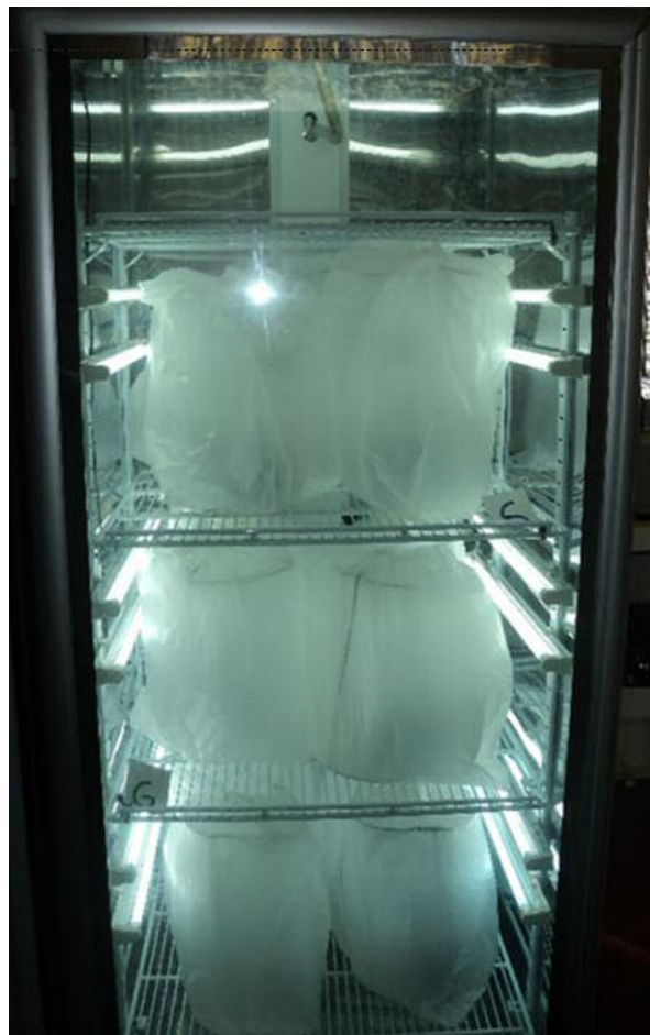
Figura 6. Cámara de crecimiento con las cámaras individuales cerradas con bolsas de polietileno de alta densidad durante la exposición a los vapores de 2,4-D.
