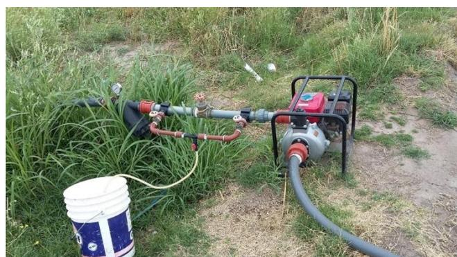
Figura 86. Fertilización con equipo Venturi en riego de melón a campo, mediante motobomba de riego, Pedro Luro.
