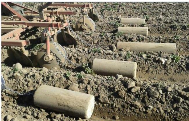
Figura 24. Balas de cemento compactadoras de fondo de surco en cultivo de papa. Fuente: Roqué, C. *et. al.*, *s.f.*
