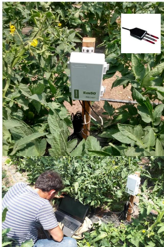
Figura 88. Monitoreo de la humedad del suelo a distintas profundidades mediante sensores de humedad en cultivo de tomate bajo cubierta, Pedro Luro.
