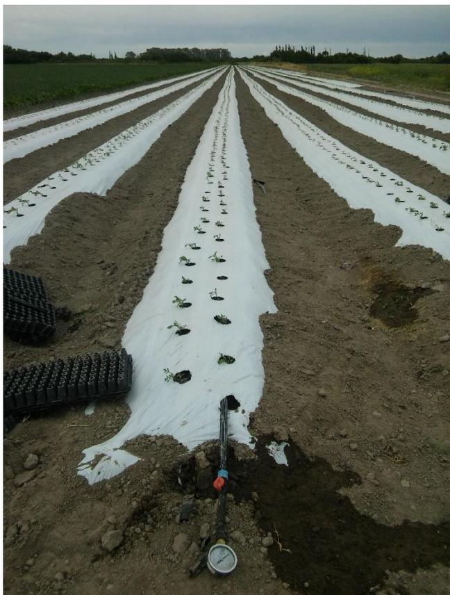
Figura 80. Control de la presión con manómetro en el final de línea.
