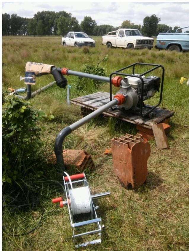
Foto 51. Toma de agua de perforación con motobomba para riego por goteo, Mayor Buratovich.
