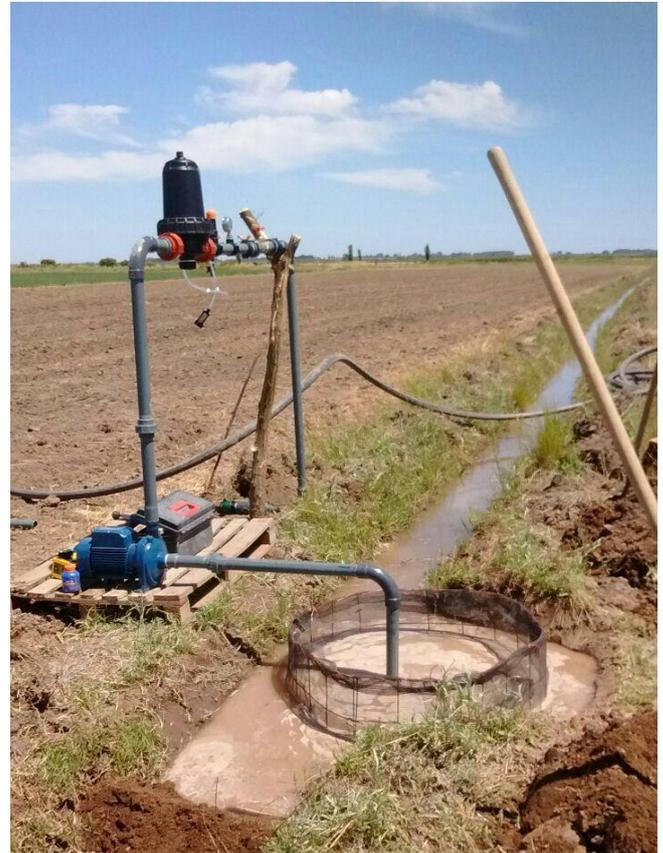
Figura 67. Canasto de filtrado en la toma de agua, Hilario Ascasubi.
