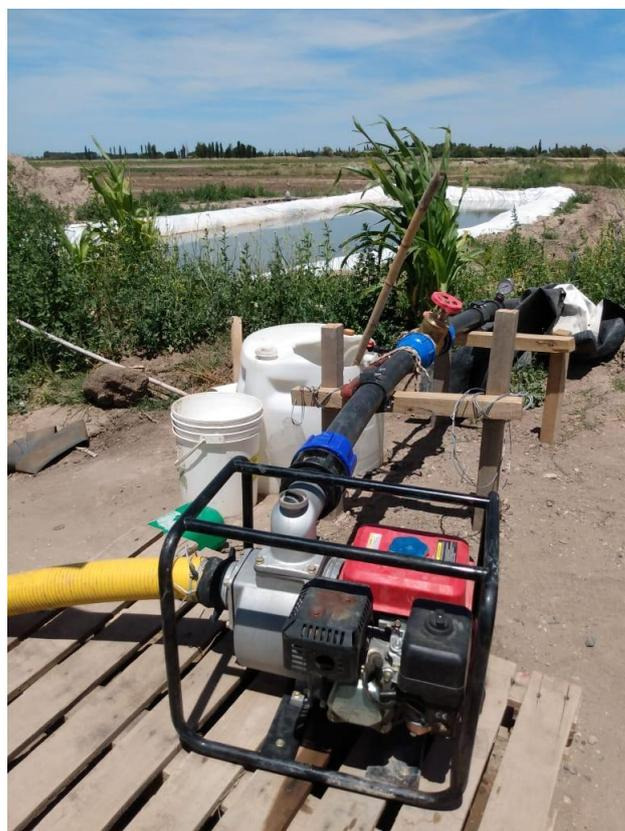
Figura 61. Motobomba utilizada para riego presurizado en producción bajo cubierta, Mayor Buratovich.
