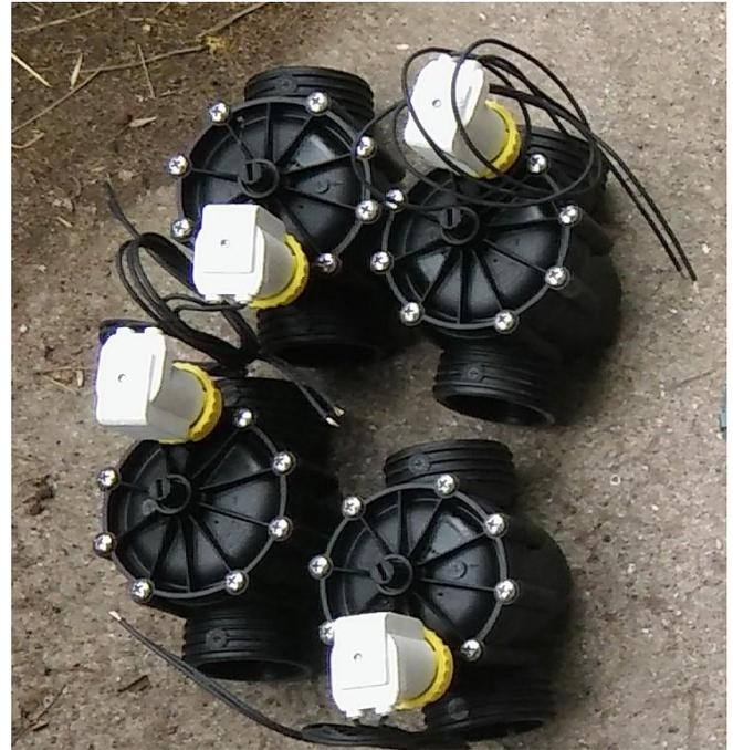
Figura 96. Válvulas solenoides o electroválvulas de riego.
