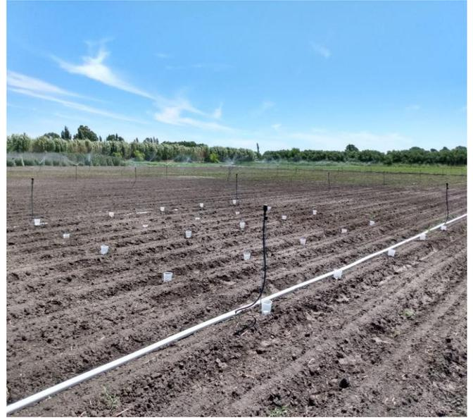
Figura 94. Evaluación a campo de la uniformidad de riego en aspersores rotatorios de alto impacto con recipientes plásticos, Pedro Luro.
