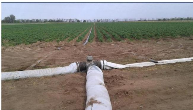
Figura 29. válvulas comerciales de riego por pulsos con alas regadoras de polietileno (mangas) con compuertas derivadoras y calcetines de polietileno Fuente: Roqué *et. al. s.f.*
