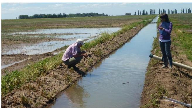
Figura 12. Medición de la velocidad del agua en acequia mediante elemento flotante y cronómetro.
