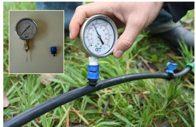
Figura 79. Manómetro con aguja y toma manométrica.
