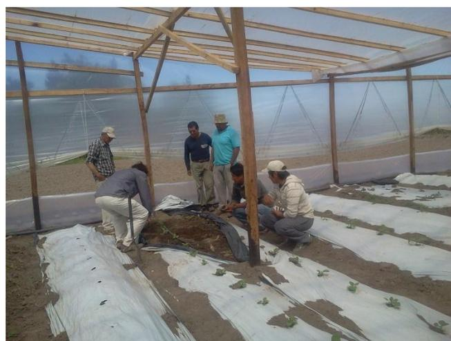
Figura 56. Observación a campo del bulbo húmedo luego del riego por goteo en invernadero, Juan A. Pradere.
