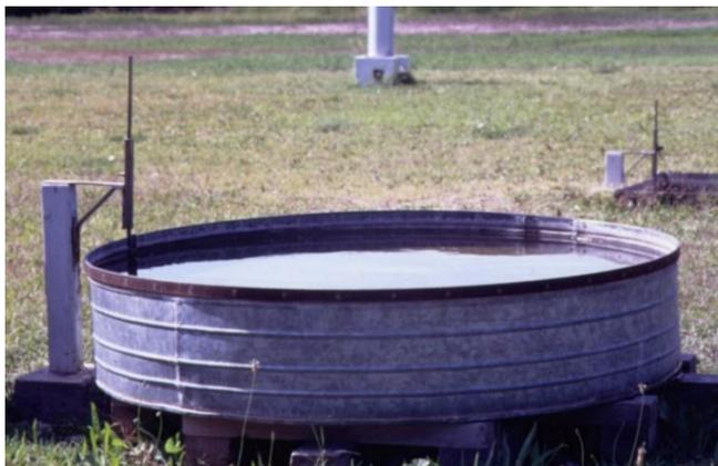
Figura 87. Tanque evaporímetro tipo A.
