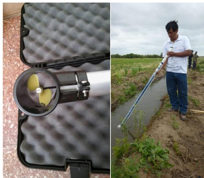
Figura 13. Mini molinete para la medición de la velocidad de un curso de agua.
