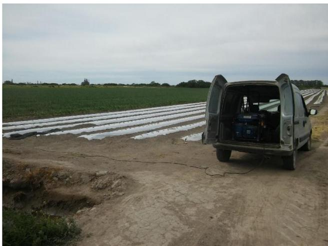
Figura 44. Uso de generadores eléctricos para el riego con electrobombas centrífugas, Juan A. Pradere.
