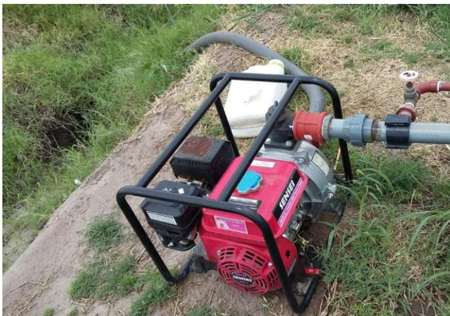
Figura 62. Motobomba utilizada para riego presurizado a campo, Pedro Luro.
