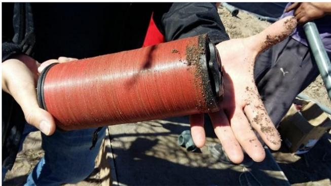
Figura 98. Anillas del filtro de anilla, con sedimentos de agua de perforación, Juan A. Pradere.
