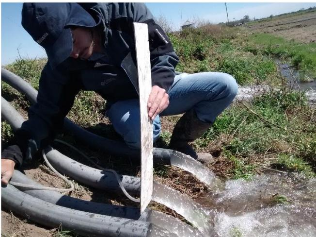
Figura 18. Aforo de sifones de riego de PVC de 3 pulgadas, mediante manguera de nivel y la tabla de aforo.
