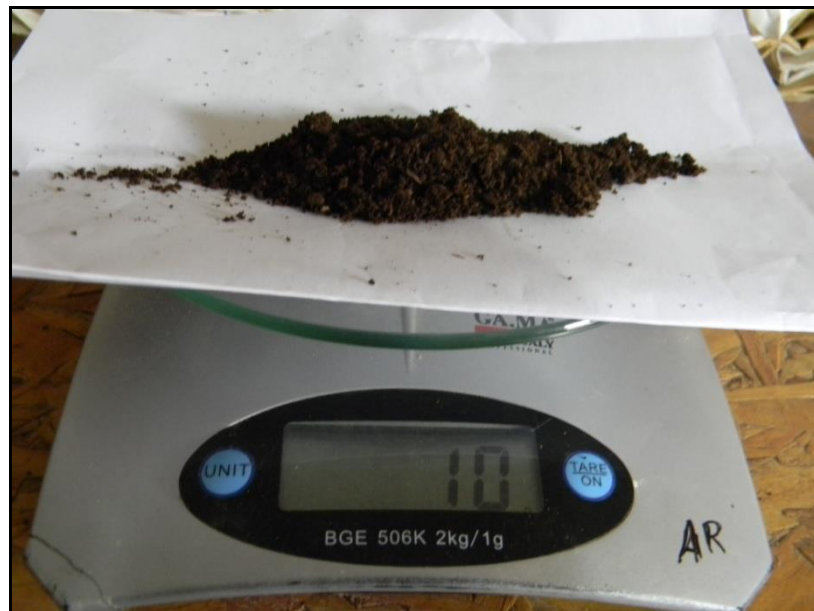
Imagen 5: Pesado de muestra de estiércol de cabra previo a la preparación de solución para determinar conductividad eléctrica.
