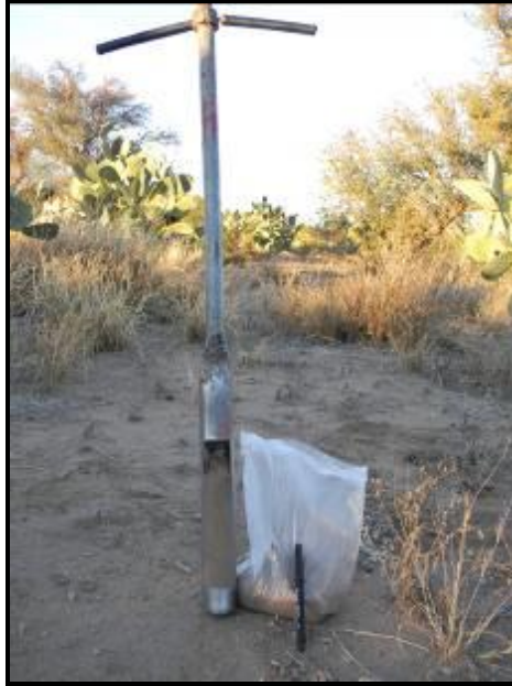
Imagen 11: Muestra de suelo y pala barreno utilizado para la toma de muestras.
