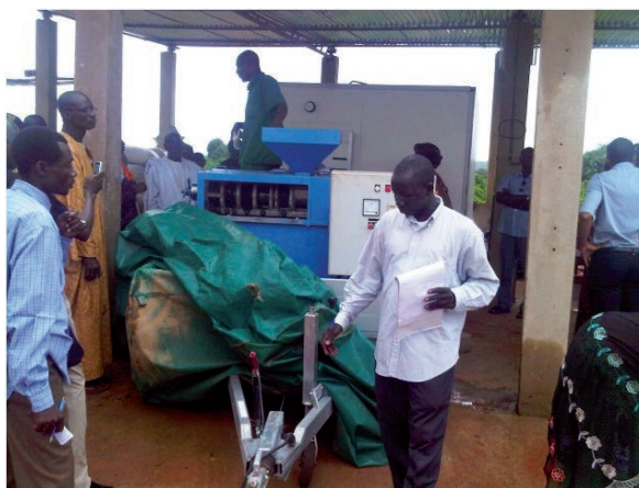
Figura 4.11. Prensa móvil de MaliBiocarburant montada en un trailer
