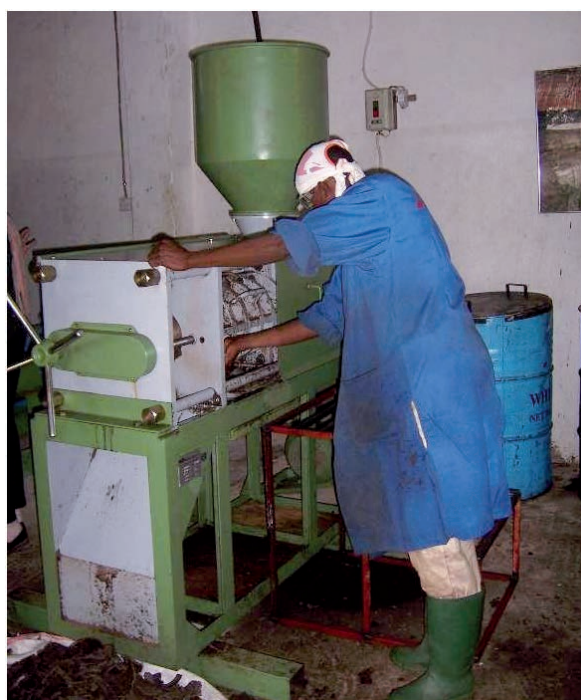
Figura 4.8. Prensa de jatropha de pequeña escala (Tanzania)
