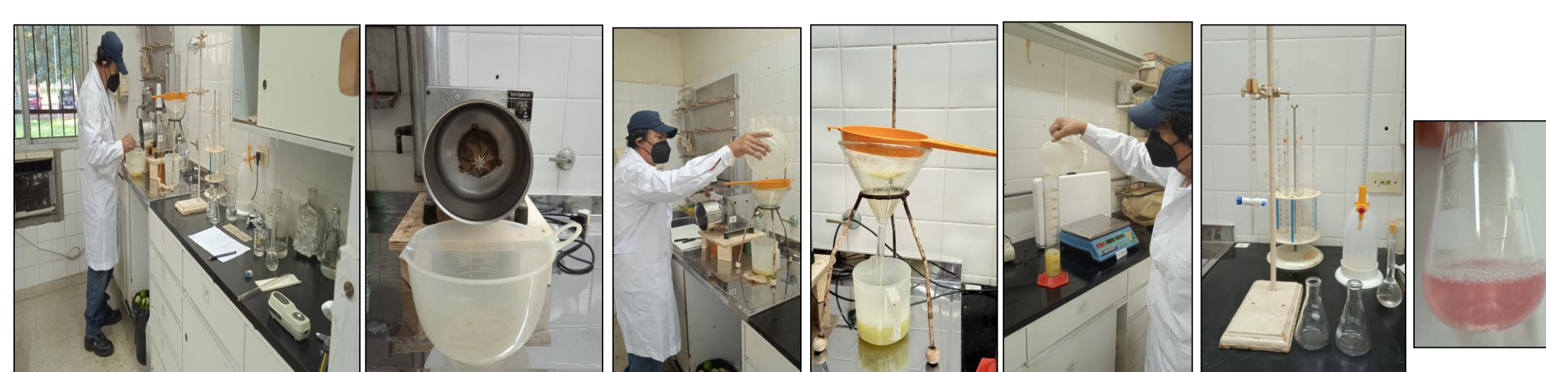
Figura 5. Secuencia de análisis de muestras (Extracción de jugo, separación de semilla y pulpa, medición ml de jugo y titulación acidez)
