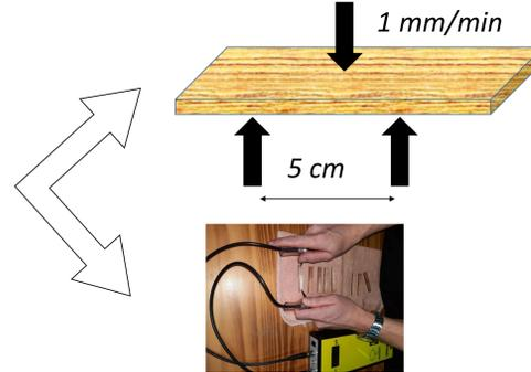
Flexión en tres puntos Según Siegel et al. [1] para chapas. (máquina universal INSTRON 3369)
