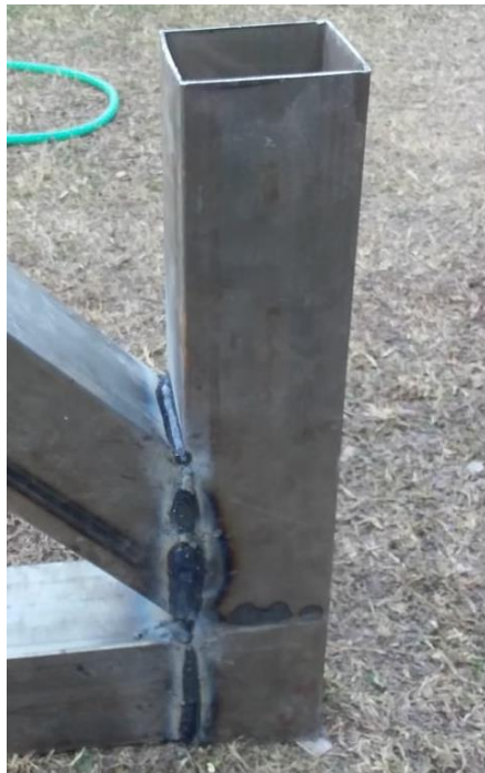
Figura 10. Soldadura hecha a escuadra.
