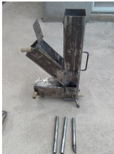
Figura 11. Corte de caños a 20 cm de \frac{1}{2} " (patas). Hierros de 5 cm de largo soldados en la base de la cocina que permiten el encastre de las patas.
