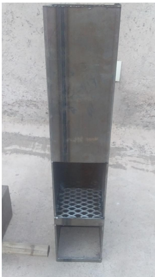
Figura 8. Separación de la cámara de aire y carga de leña con material desplegable soldado a la chimenea.
