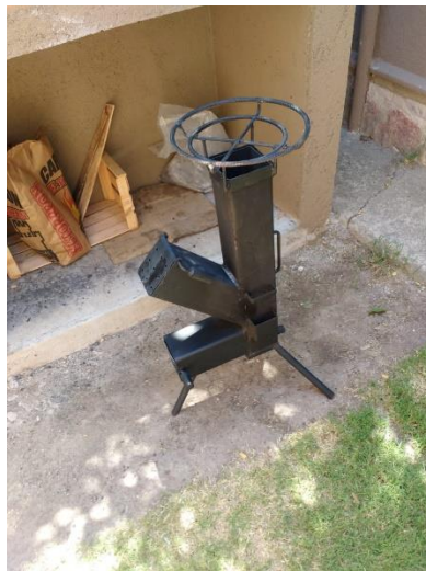
Figura 14. Cocina terminada. Es muy importante que la hornalla quede elevada desde la salida de la chimenea, cerca de 10 cm, para garantizar su correcto funcionamiento.
