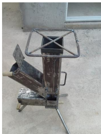
Figura 12. Detalle del armado y soldadura de la hornalla hecha de hierro nervado (8 mm), de 20 cm x 20 cm
