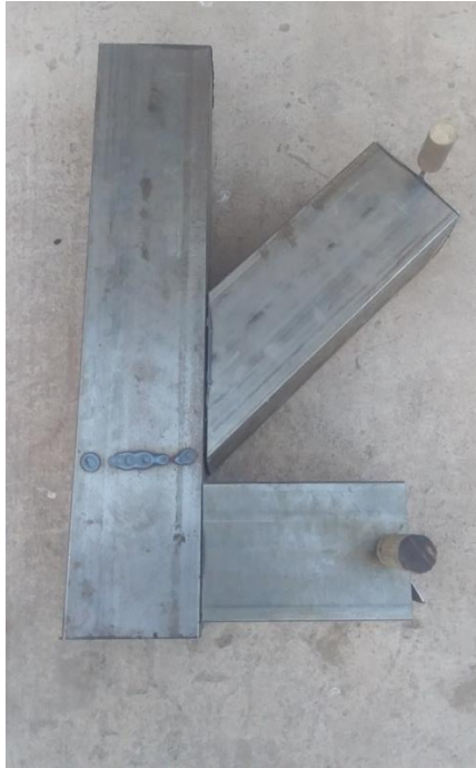
Figura 9. Piezas ensambladas y soldadas.
