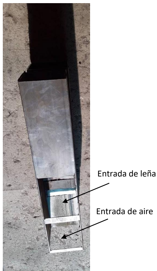
Figura 2. Frente del caño chimenea con dos orificios. El superior que es a donde se coloca el caño de entrada de leña y el inferior que es por donde se inserta el caño de entrada de aire.
