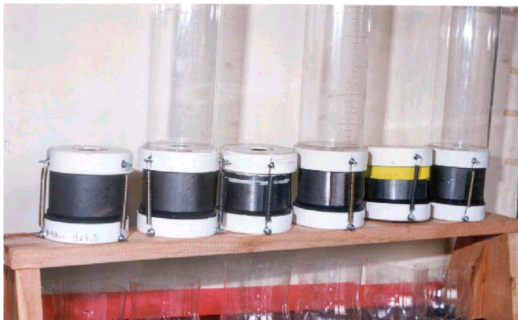
Foto: Cilindros para medir Conductividad hidráulica saturada
