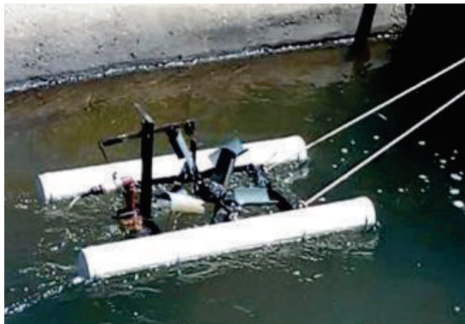
Figura 2: Modelo anterior de la noria funcionando en un canal.
