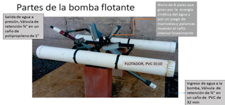
Figura 3: Partes de la bomba flotante.
