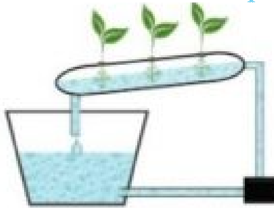
Figura 2.4: Esquema de un sistema NFT
