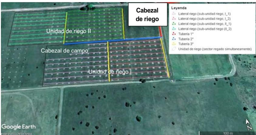
**Figura 6. Esquema de sistema de riego presurizado, con sus diferentes componentes.**
