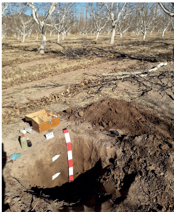
Figura 19. Descripción de perfil de suelos mediante apertura de calicata en un monte de nogales (Villa Calingasta, abril 2021)
