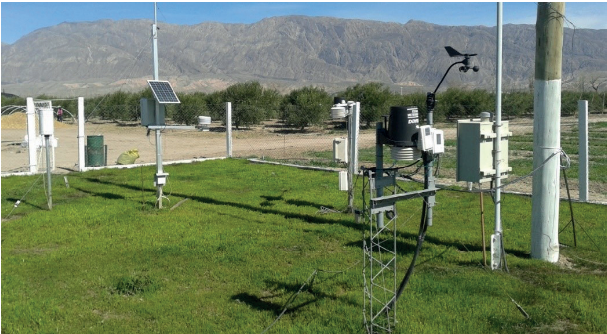
Figura 27. Estación meteorológica del INTA con cobertura verde para cumplir con los requisitos de funcionamiento que recomienda la FAO. Fuente: Alfredo Olguín
