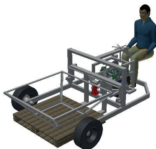
Figura 31. Prototipo de acarreador de canastos Fuente: Nicolás Serafini
