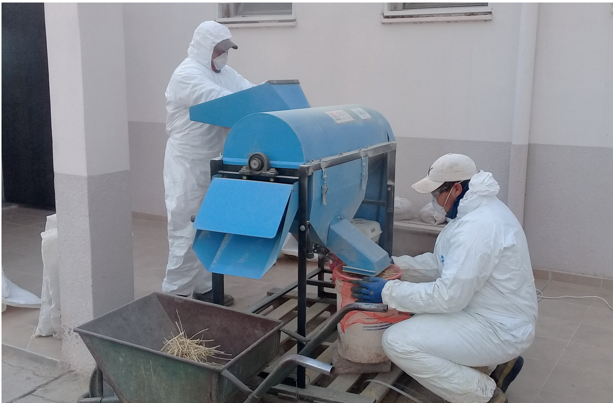
Figura 14. Trilla de panojas de quinua en AER Calingasta, empleando trilladora portátil. Fuente Nadia Barcena
