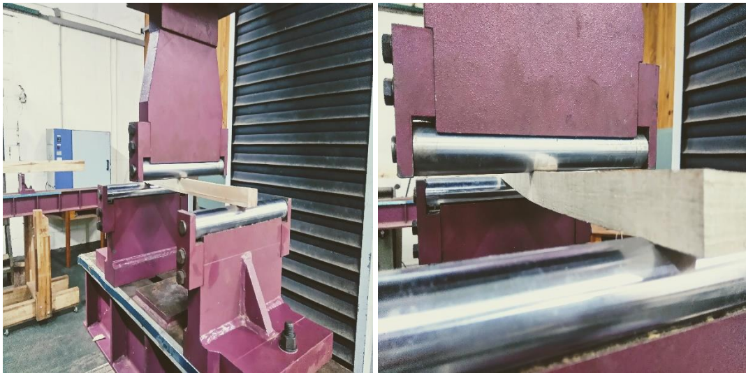
Figura 11. Ensayo de flexión estática. Máquina universal de ensayos de laboratorio de tecnología de la madera. FACULTAD DE CIENCIAS FORESTALES-UNaM-IMAN.
