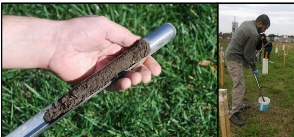
Figura 5. Colecta de muestras de suelo utilizando barreno.
