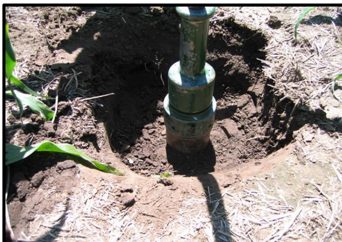
Figura 9. Toma de muestras para determinar densidad aparente del suelo con sacamuestras.
