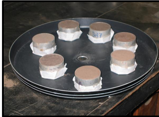
Figura 10. Muestras no disturbadas para determinar retención de agua en el suelo.
