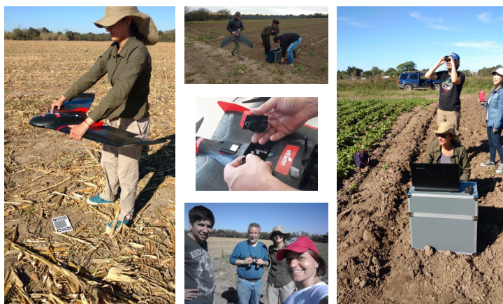
Figura 4.6: Equipo de trabajo, ejecución de vuelo y calibración radiométrica de los sensores multispectrales Parrot Sequoia+.
