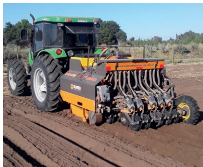
Figura 3. Izquierda: sembradora neumática utilizada. Derecha: disposición de la siembra en surco con 4 líneas.
