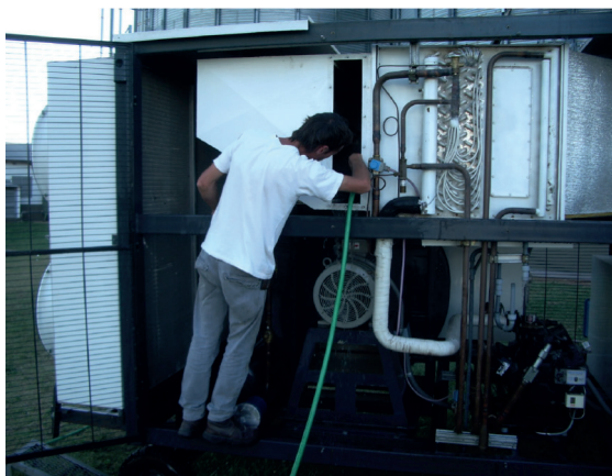
Limpieza de los filtros de aire y evaporador de un equipo refrigerador de granos.
