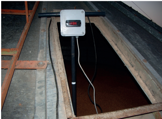
Figura 22. Inserción de lanza para medir temperatura en la parte superior del silo.
