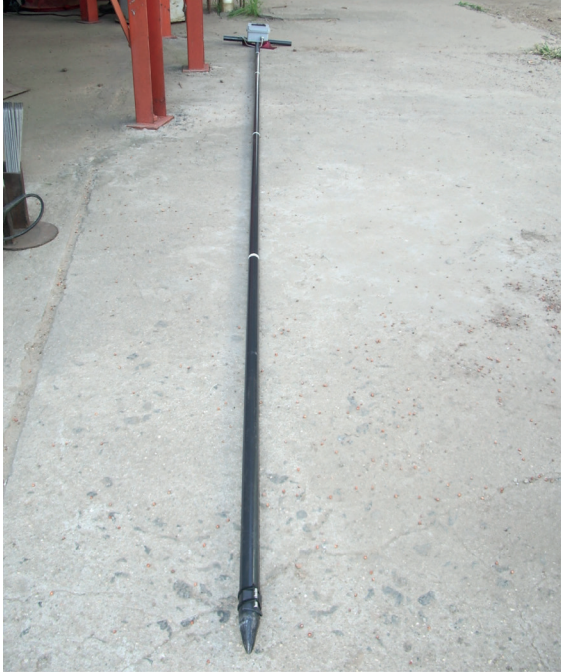
Figura 21. Lanza con una longitud de 3,8 m y visor digital.
