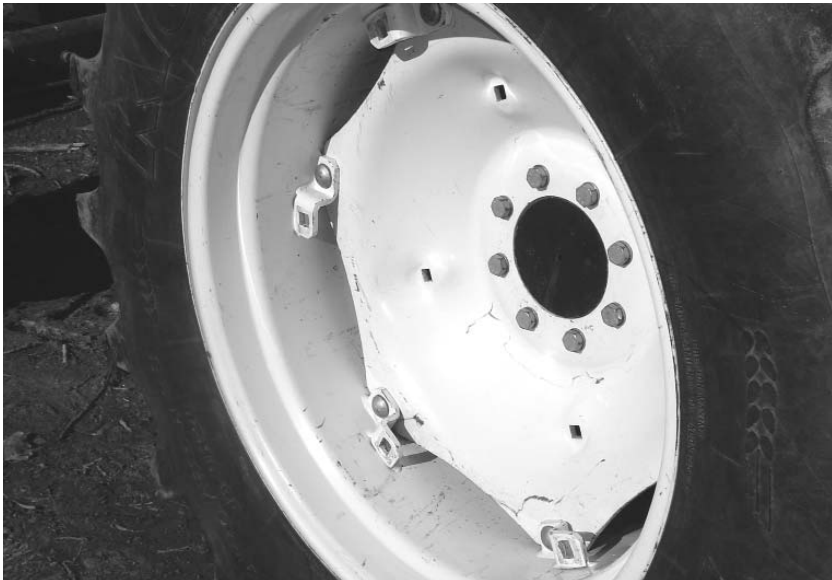
Figura 22. Regulación de la trocha del tractor
