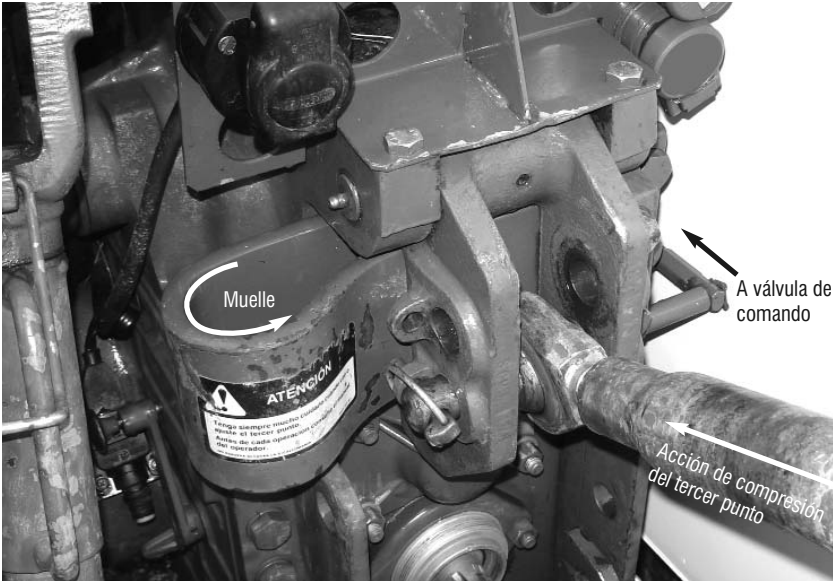
Figura 32. Sensor de control de esfuerzo. Su comportamiento dinámico
