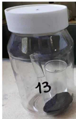
Figura 3.8. Muestras estructurales (ME) preparadas para incubar junto al vial de NaOH y al tubo de ensayo con agua destilada para mantener la humedad constante.
