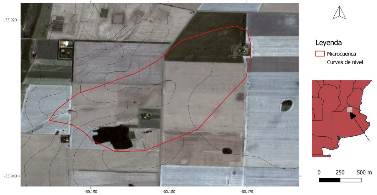
Figura 2.1. Microcuenca bajo estudio. Imagen Google Earth y carta topográfica con equidistancia de 2,5 metros. El cierre de la microcuenca se realiza en el punto de instalación del limnígrafo registrador de escurrimientos.
