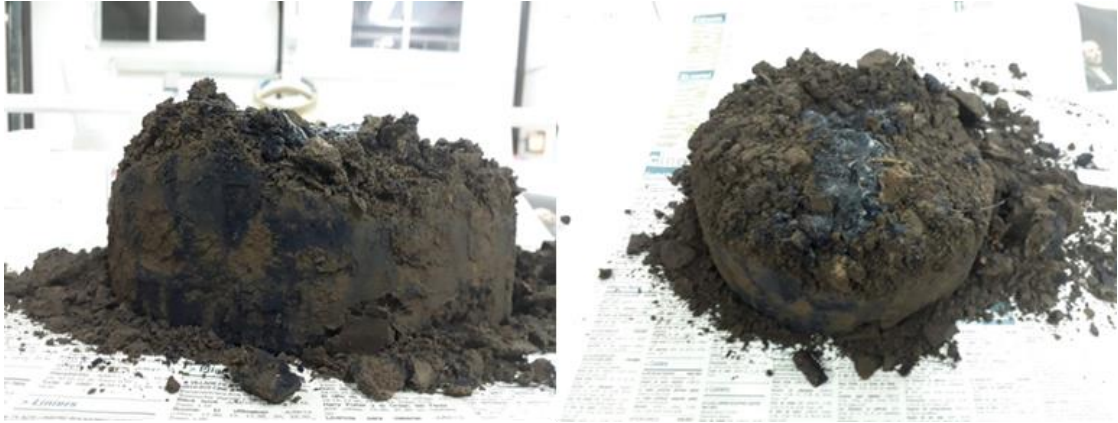
Figura 3.6. Monolitos de suelo luego de ser separados de las parcelas metálicas y teñidos con el colorante azul brillante para la evaluación del movimiento del agua dentro del monolito mediante observación directa.
