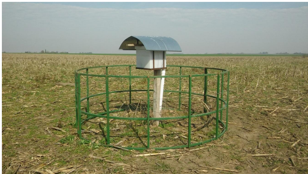
Figura 2.2. Limnógrafo instalado en cercanías de la vaguada.
