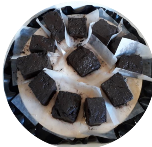
Figura 3.7. Muestras estructurales (ME) dispuestas en placa porosa previo a ser ingresadas a la olla de presión para luego ser incubadas.
