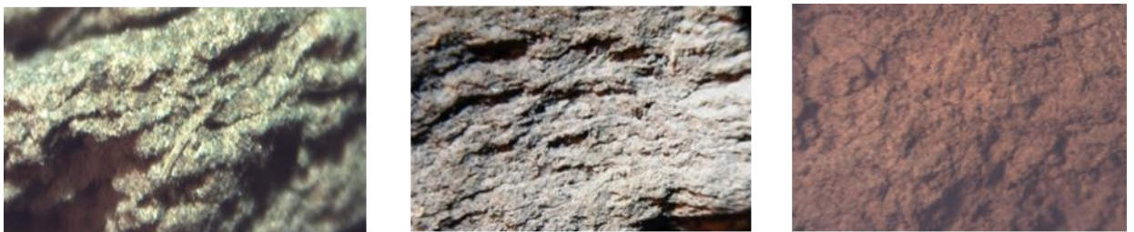
Figura 3.16. a) Observación macroscópica y b) microscópica (X5) de las estructuras laminares débiles (LD), laminares (L) y no laminares (NL).
