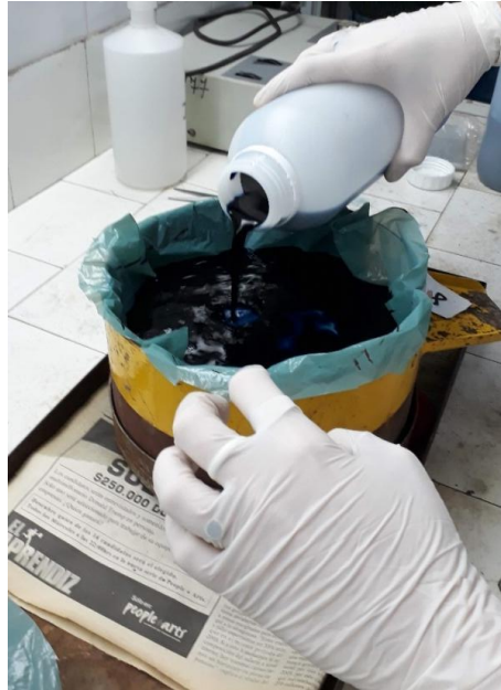
Figura 3.5. Aplicación de la solución de azul brillante sobre una parcela con suelo sin disturbar con el objetivo de evaluar el ingreso, el movimiento del agua dentro del monolito y las estructuras edáficas presentes.
