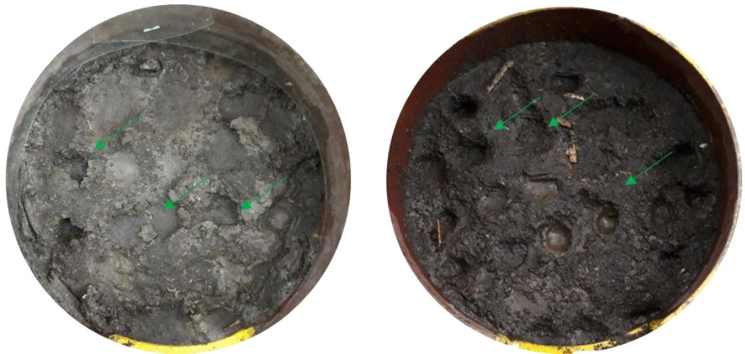
Figura 3.14. Detalle de los pequeños cráteres superficiales favorecidos por el impacto de la gota de lluvia luego de los ensayos de simulación de lluvia en las parcelas sin cobertura ( SC ).
