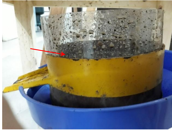
Figura 3.4. Parcela al momento del ensayo de simulación de lluvia. Detalle de protección contra salpicadura.
