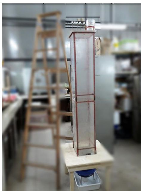
Figura 3.3. Simulador de lluvia adaptado para la realización del ensayo de dinámica hídrica en el laboratorio sobre parcelas con suelo no disturbado.
