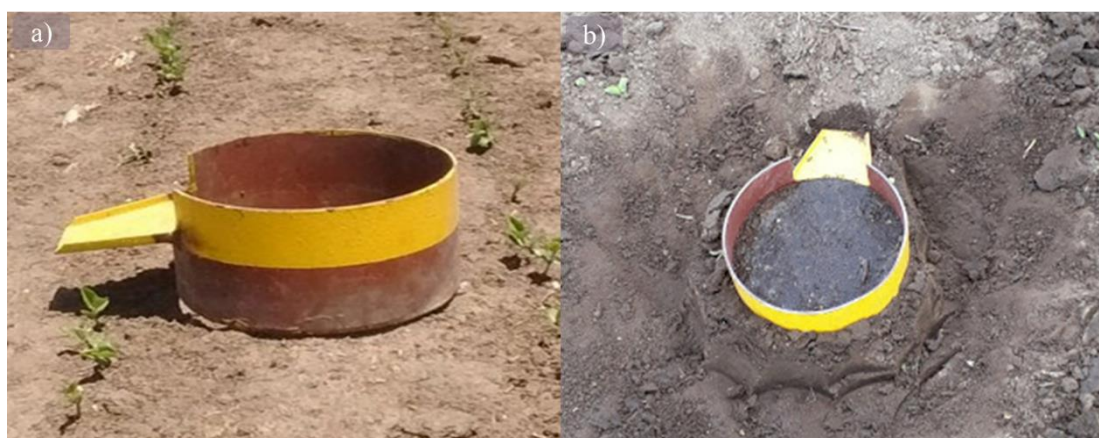
Figura 3.1. a) Parcela metálica dispuesta en el terreno previo a la extracción del suelo sin disturbar, b) Extracción de parcela, luego de la aplicación de agua superficial.
