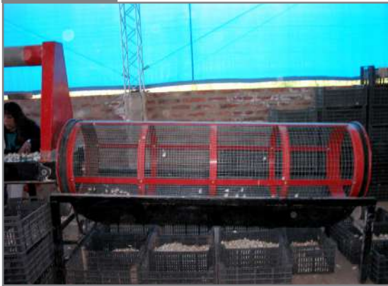
Clasificadora de dientes lineal de malla. Fuente: A.M. López.
