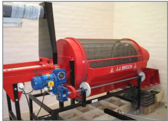
Clasificadora de dientes concéntrica de malla. Fuente: A.M. López.
