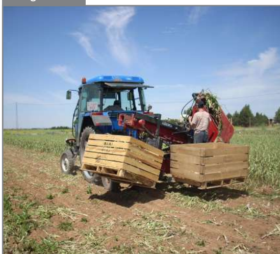
Arrancadora destalladora. Fuente: A.M. López.
