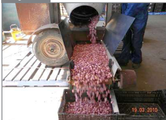
Hormigonera adaptada a la desinfección de semilla por el método de “embarrado” Fuente: A.M. López.
