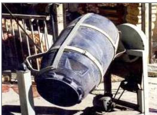
Tambor excéntrico de accionamiento eléctrico para tratamiento de diente-semilla. Fuente: A.M. López.
