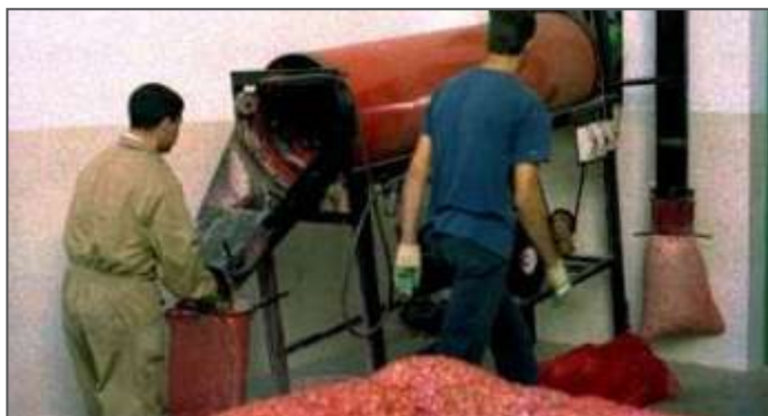
Hormigonera adaptada a la desinfección de semilla por el método de “embarrado” Fuente: A.M. López.
