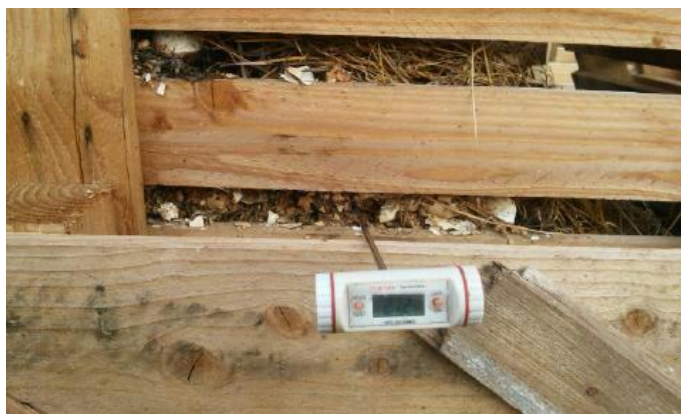
Figura 3.7 Registro de temperatura con termómetro pinche
