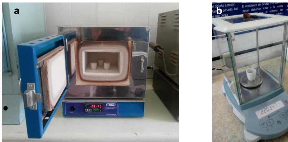
Figura 3.14 Mufla y balanza durante la determinación de materia orgánica
