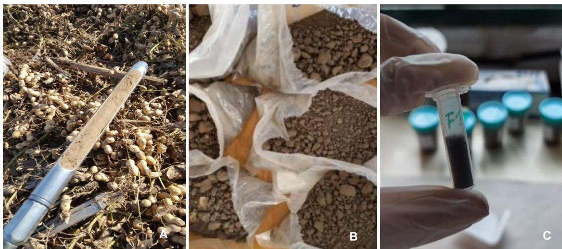
Figura 2. A. Muestreo de suelo a 5 cm de profundidad utilizando sacabocado B. muestras de suelo en proceso de secado a temperatura ambiente C. conservación de 2 g de muestra de suelo luego del procesamiento (secado, tamizado, cuarteado).
