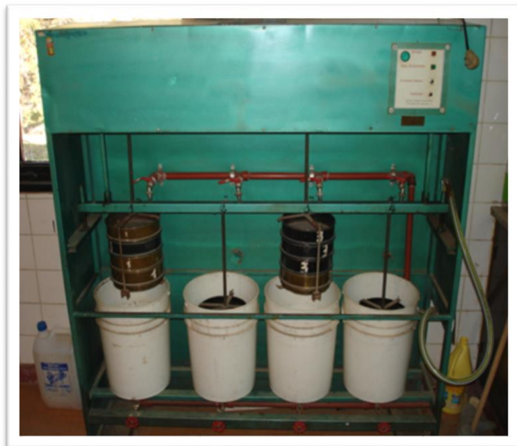
Foto 7. Detalle del equipo utilizado para el tamizado en húmedo de los agregados de acuerdo con la metodología propuesta por De Boodt y De Leenheer (1967).
