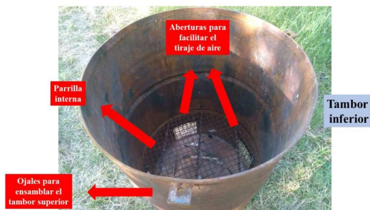
Figura 1: Tambor inferior del calcinador artesanal
