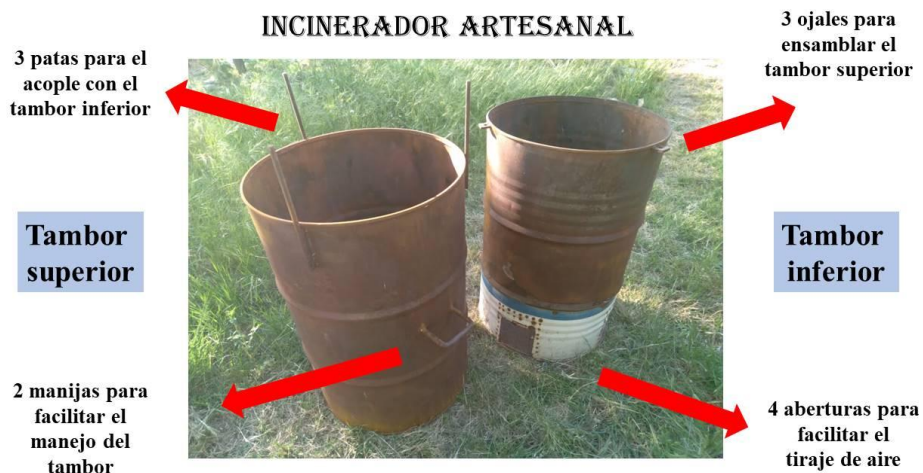
Figura 2: Descripción de los componentes del calcinador artesanal
