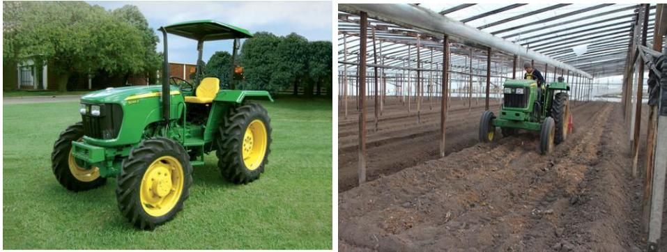
**Figura 1.** Izquierda Tractor John Deere 45 HP doble tracción. Derecha. El mismo tractor sin techo cabina y escape de gases hacia abajo, adaptaciones para el trabajo en el invernadero
