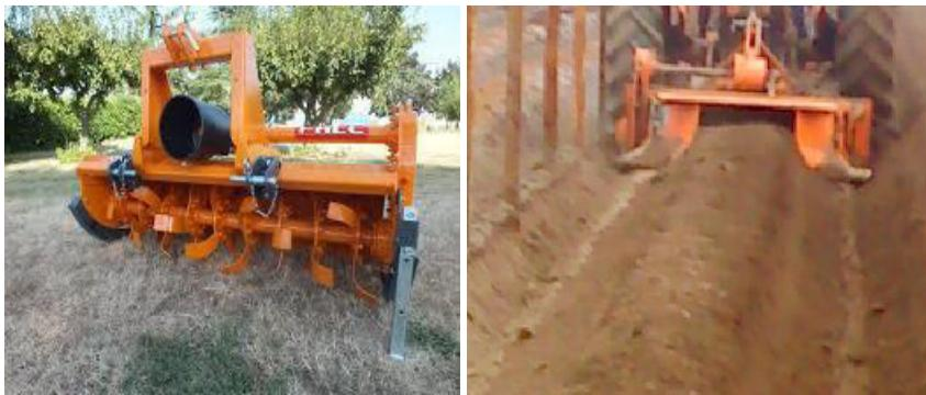
**Figura 3.** Rotovactor (izquierda) y Rotovactor con alomadora (derecha)
