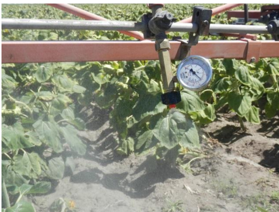
Figura 1: Vista panorámica de la pulverización sobre el girasol confitero en las experiencias realizadas en la EEA Hilario Ascasubi durante 2015 (arriba). Medición de presión en la línea de pulverización (abajo, izquierda). Capitulo inclinado 180° con tarjeta hidrosensible (abajo, derecha).
