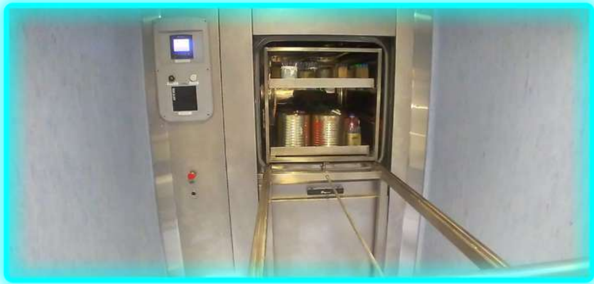
Figura 1. Autoclave de frontera con los materiales adentro.
