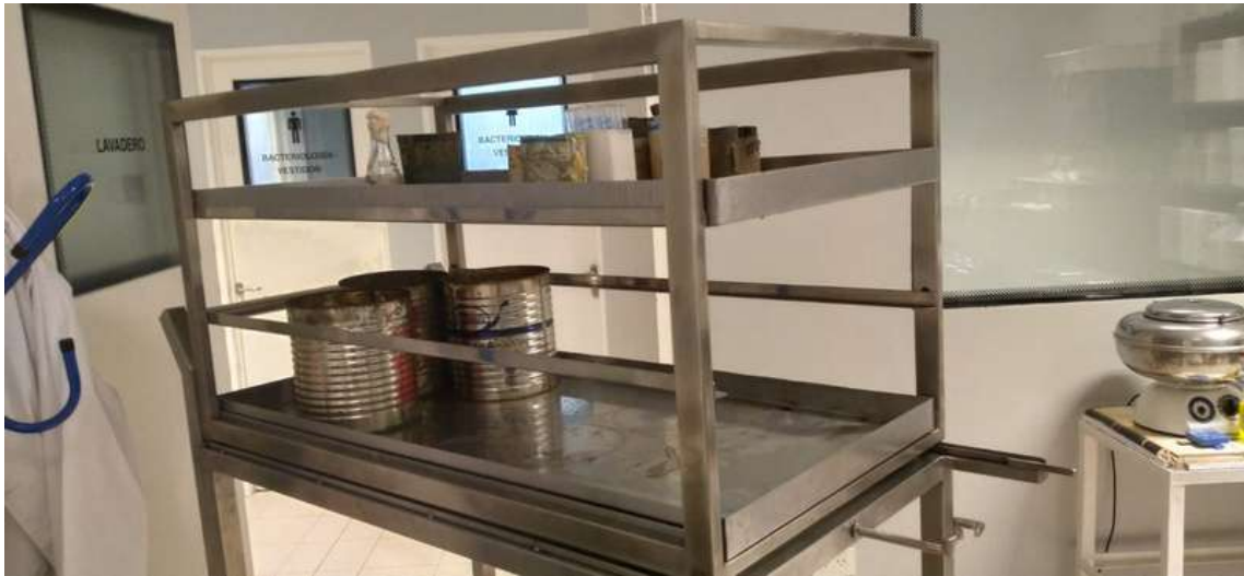
Figura 8. Colocación de los recipientes en los estantes del carro, que ingresan y egresan del autoclave de frontera.
