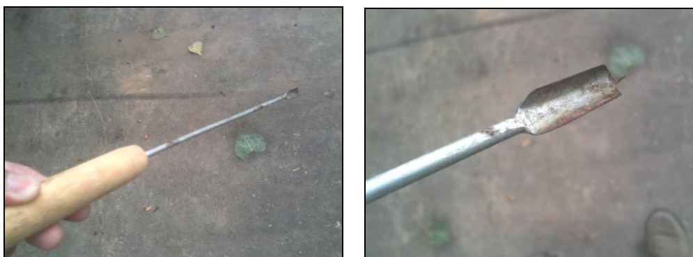
Figura 12 - Gubia para la extracción de "canutos" de ajo comestibles
