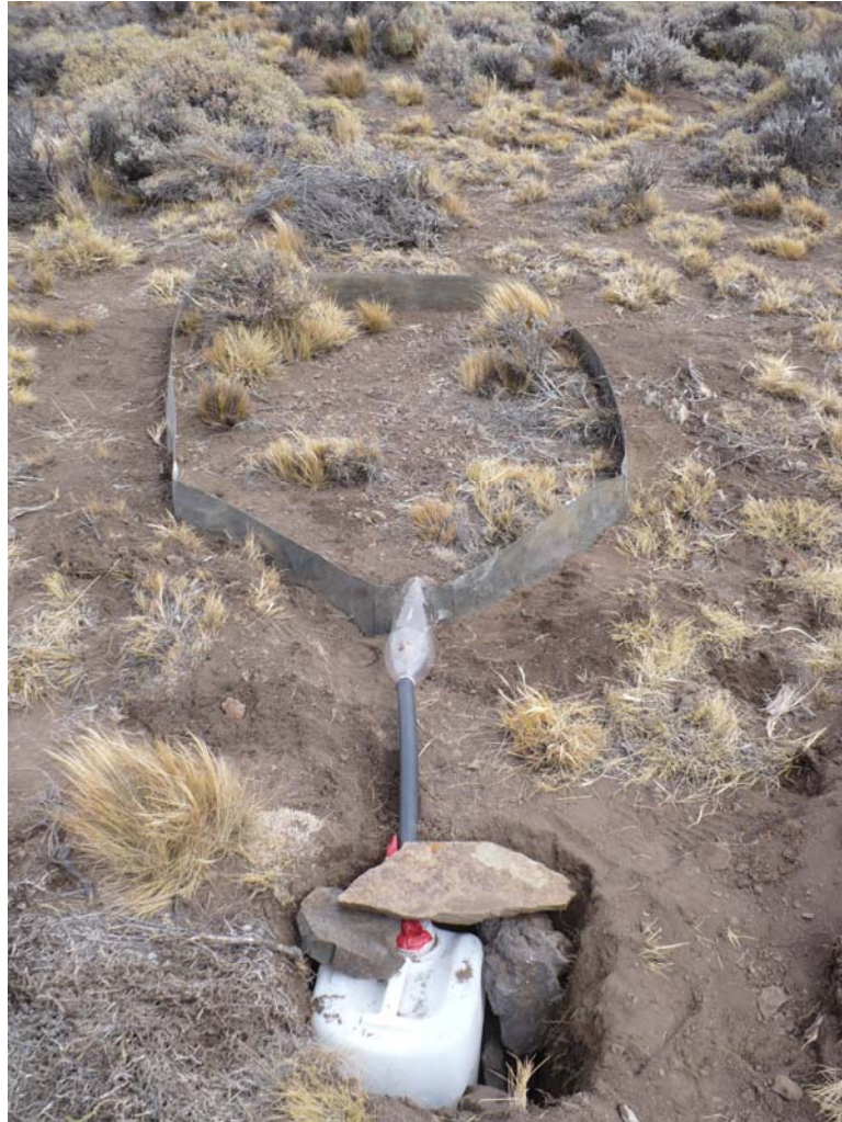
Imagen 6. Fotografía de una micro parcela de erosión instalada.
