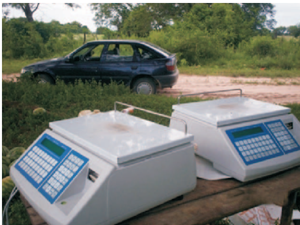
Figura 15. Balanza de precisión para determinar el peso de las frutas. Permite obtener el código de barra impreso en cada fruta.
