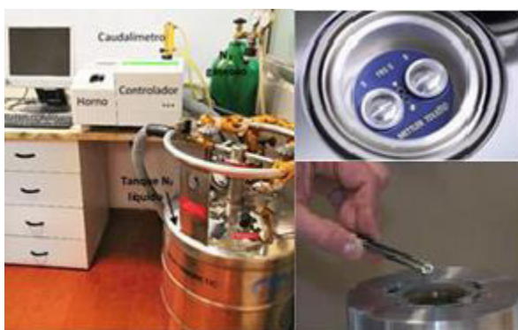
Figura 1. Fotografía de un equipo de DSC (a), detalle del horno con los crisoles conteniendo la muestra, S y la referencia R, posicionadas sobre los sensores (b) y colocación de las muestras en el horno (c)
