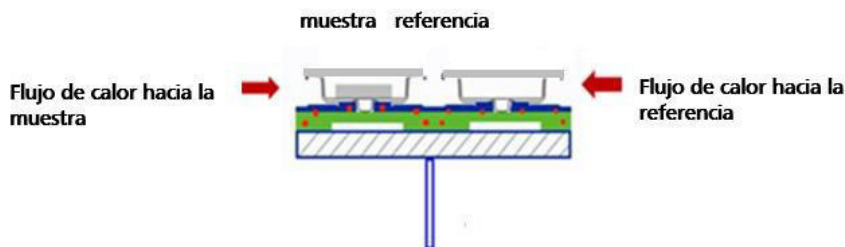
Figura 2. Detalle de la ubicación de los crisoles de la muestra y la referencia sobre los sensores en el horno del DSC
