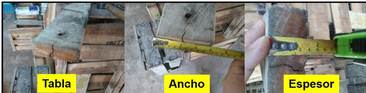
Figura 31. Tabla aserrada para canaleta: dimensiones
