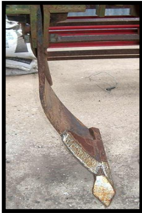
Figura 3. Diseño y disposición de los timones sobre el chasis en el equipo con Timón Curvo.
