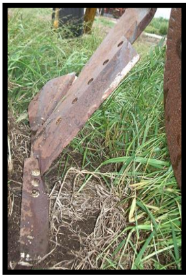
Figura 2. Diseño y disposición de los timones sobre el chasis en el equipo con Timón Angulado.
