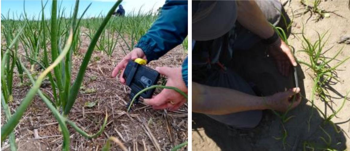
**Figura 13.** Medición del LAI mediante smartphone.
