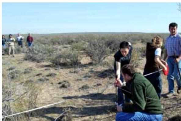
*Una vez establecida la línea principal y los puntos 2, 3 y 9 se establecen en forma perpendicular los puntos 4, 5, 6, 7, 8 y 10 utilizando una escuadra óptica.*
