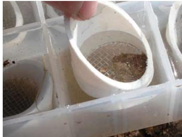
Los agregados se colocan en pequeños tamices y se introducen en agua. Se extraen y vuelven a sumergir dos veces a los 5, 20 y 60 segundos y se evalúa cuanto material queda en la malla
