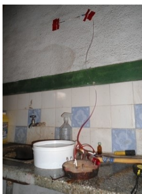
Foto 4. Metodología de muestreo. A modo ilustrativo se observa el dispositivo armado para la determinación del ks .
