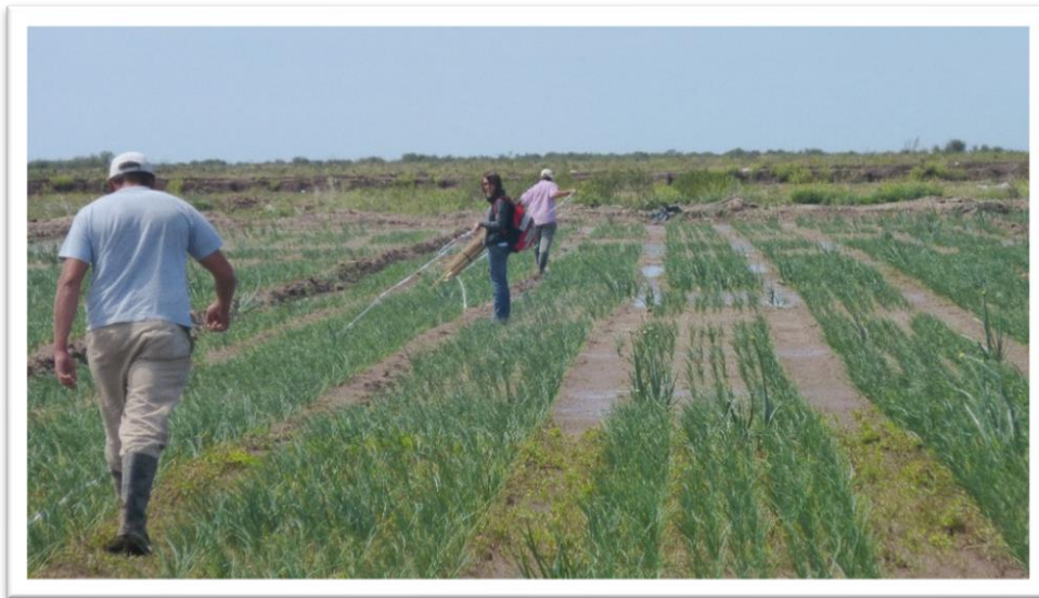
Figura 25. Medición a campo de largo y ancho de la unidad de riego bajo estudio con cintas métricas.
