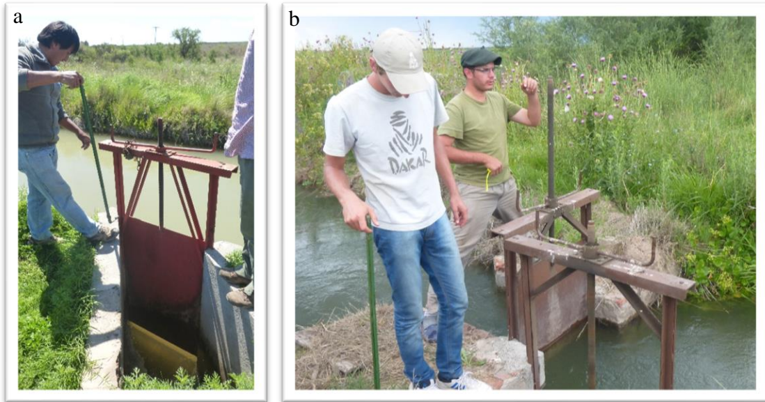
Figura 15. Aforo de compuertas libres (a) y ahogadas (b) durante las evaluaciones de riego.
