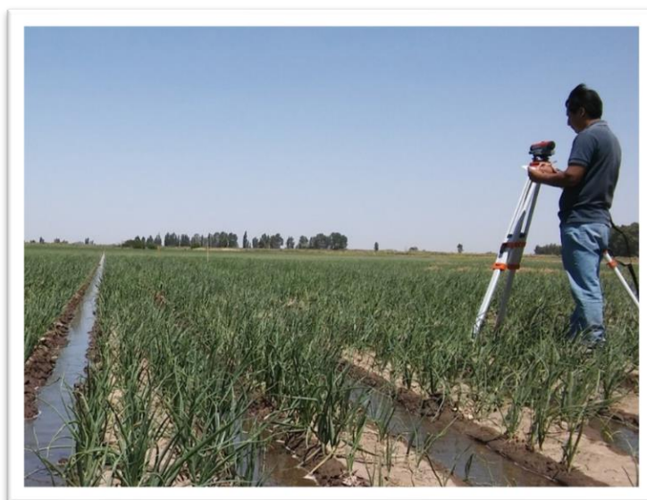
Figura 24. Estudio de la pendiente en un lote de cebolla regadas por surcos mediante nivel de anteojo marca Pentax AL -321 32x.
