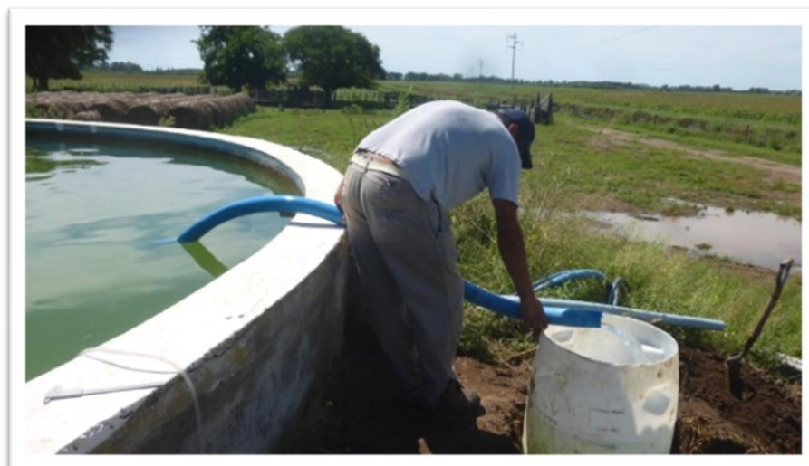
Figura 19. Aforo volumétrico de los sifones de riego en la EEA Hilario Ascasubi del INTA.
