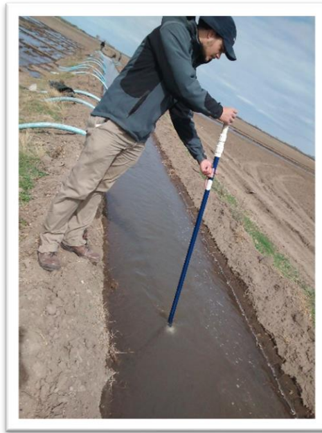
Figura 17. Medición de la velocidad de circulación del agua en acequia con Molinete de hélice Global Water.
