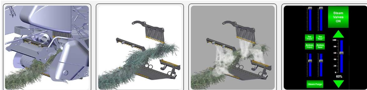
Figura 3: Las 4 barras de aplicación de vapor son comandadas desde la cabina del tractor mediante monitor exclusivo para la vaporizadora. Fuente: staheliwest.com
