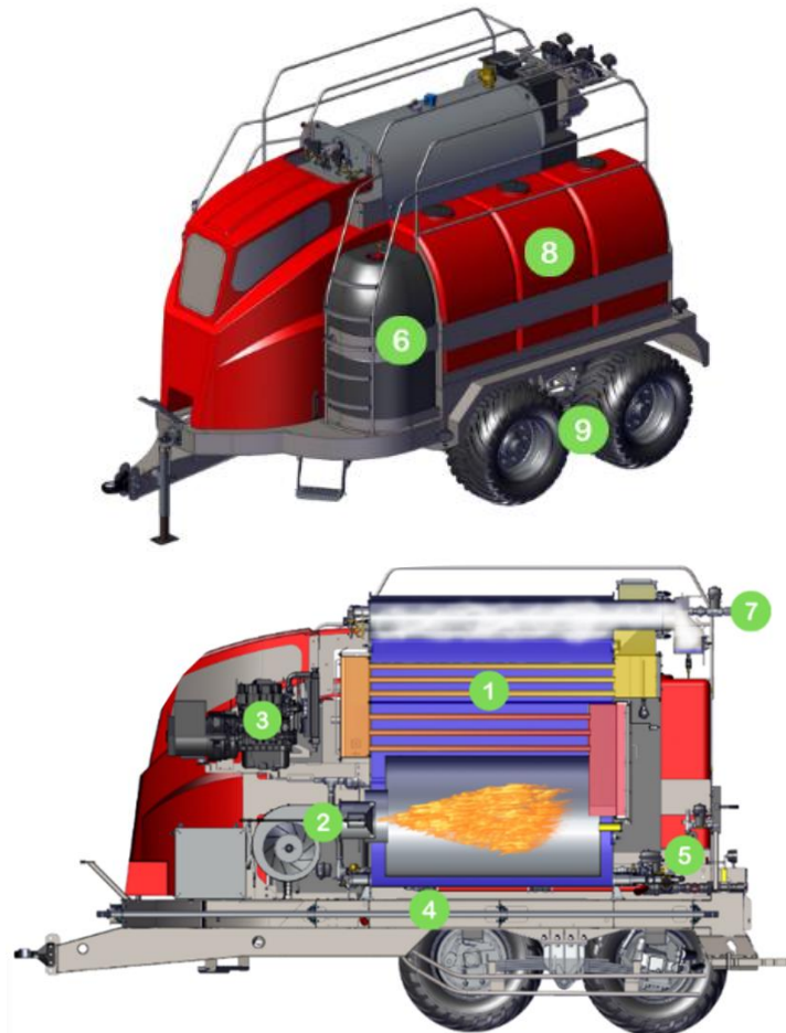
Figura 1: Detalle de la Vaporizadora: 1-caldera, 2-quemador, 3-generador diesel, 4-prolongación toma de potencia para accionamiento de megaenfardadora, 5-sistema de alimentación de agua, 6-tanques de combustible, 7-válvulas de vapor conectadas a las mangueras de conducción, 8-depósitos de agua, 9 neumáticos de alta flotación. Fuente: staheliwest.com
