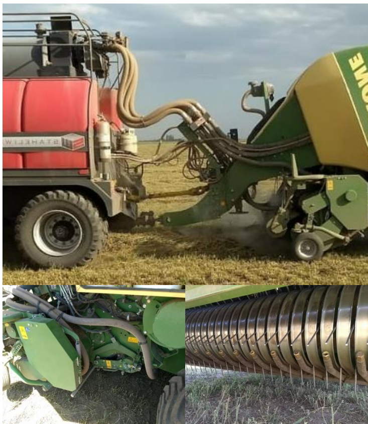
Figura 2: En la imagen superior se observa las 4 mangueras colectoras, cada una de ellas conectada a una válvula de regulación de caudal de vapor, comandadas por el maquinista desde el monitor ubicado en la cabina del tractor. Estas 4 mangueras colectoras luego derivan en 8 mangueras (dos por barra de aplicación), las cuales se observan en la imagen inferior izquierda, liberándose el vapor por las boquillas de cada una de las barras de aplicación que se observan por ejemplo en la imagen inferior derecha.
