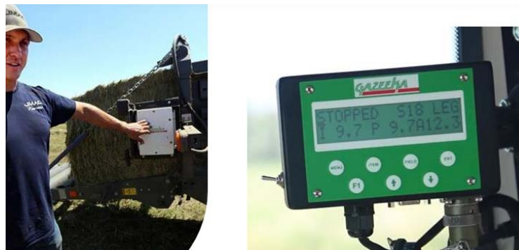
Figura 5: Sensor de humedad instalado en el canal de entrega de la megaenfardadora reportando humedad instantánea al monitor ubicado en la cabina del tractor. Fuente: Staheliwest.com
