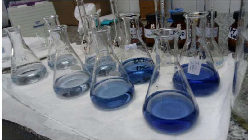
Figura 7. Escala de patrones de fósforo en mg/L por el método del ácido ascórbico.
