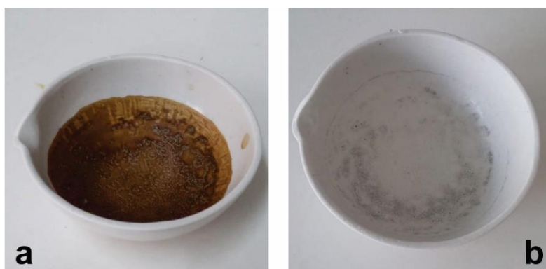
Figura 14. Calcinación de la muestra, a) muestra secada a 105 \text{ }^\circ\text{C} ; b) muestra calcinada a 550 \text{ }^\circ\text{C} .
