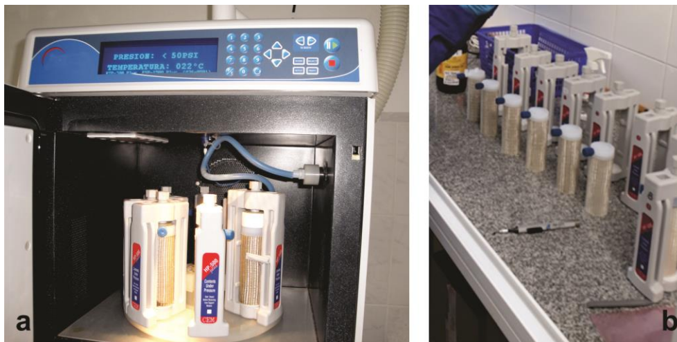
Figura 17. Digestión de las muestras en el equipo de microondas, a) tubos en el equipo; b) tubos, luego de la digestión.
