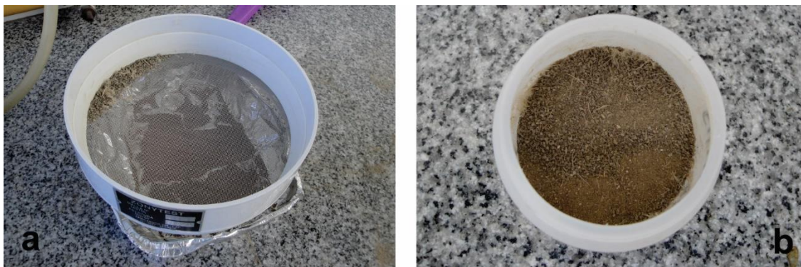
Figura 3. Molienda y tamizado de la muestra, a) tamiz de 2 mm; b) envasado de la muestra tamizada.
