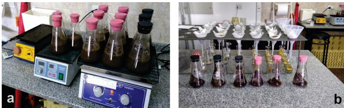
Figura 9. Preparación de los elutriados, a) agitación; b) filtración.
