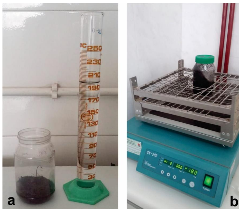
Figura 5. Preparación de la suspensión de la muestra en agua, a) Masa de la muestra y volumen del agua en una relación 1:5; b) Agitación de la suspensión.
