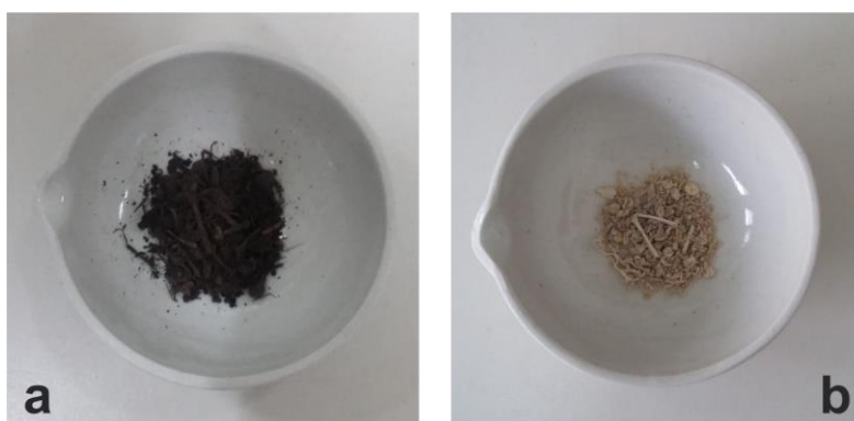
Figura 4. Calcinación de las muestras, a) muestra seca antes de la calcinación; b) muestra después de la calcinación a 550 °C.
