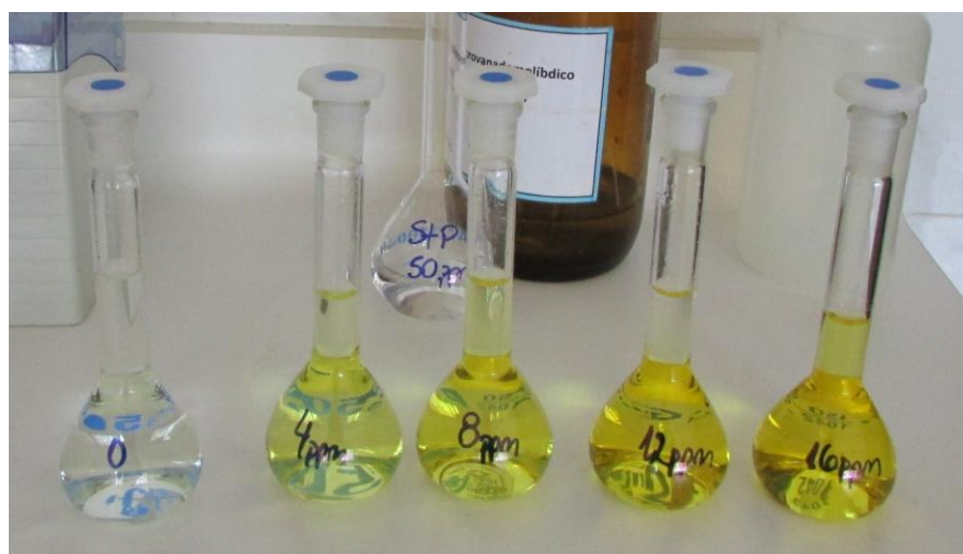
Figura 8. Escala de patrones de fósforo en mg/L por el método del ácido vanadomolibdofosfórico.
