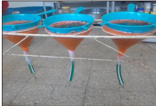
Figura 6. Dispositivos de Baermann utilizados para la recuperación de L3 en la muestra de materia fecal de las parcelas.
