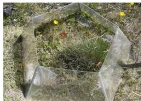
**Figura 1.** Sistema de cámara abierta (OTC) para el aumento pasivo de la temperatura media del ecosistema. La fotografía es de la cámara ubicada en un mallín méxico.
